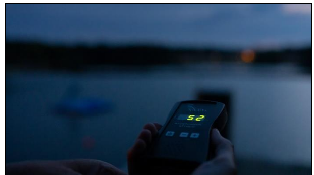
Ultraschalldetektor: Mückenfledermaus funkt auf ~52 kHz
